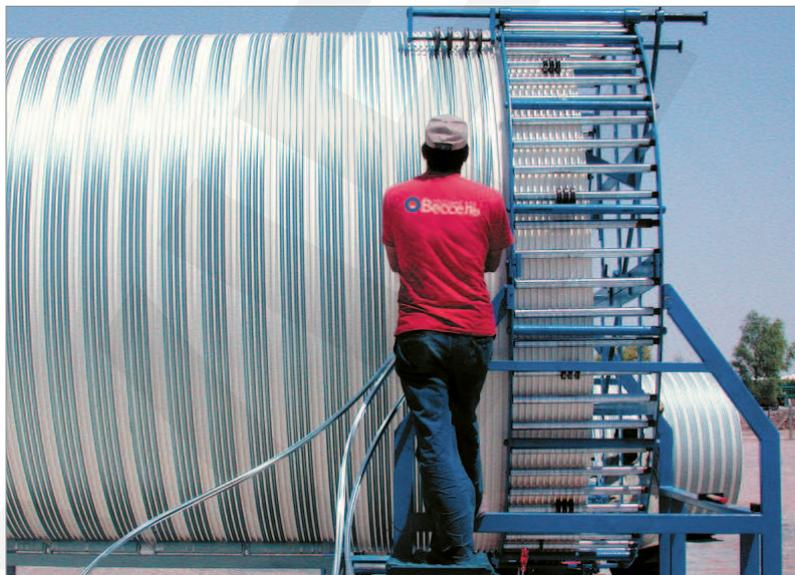
спортировки профилей *SPIRA PIPE* в специальных бобинах, создается десятикратная экономия при перевозке по сравнению с бетонными и полиэтиленовыми трубами высокой плотности (ПЭВП). Например, грузовая машина может перевезти за один раз только 14 т трубы диаметром 1500 мм, тогда как на той же машине возможна транспортировка профилей, соответствующих 127 м трубы *SPIRA PIPE*.
